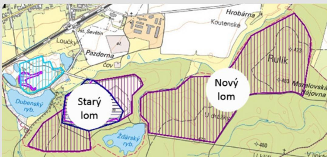
V souvislosti s otevřením nového lomu je **připravováno vybudování nové technologické linky na zpracování kamene (drtič, třídící linka, dopravníky a skládky kamene) v katastru Ševětína na pozemcích sousedících s bývalým zemědělským družstvem směrem na Mazelov na ploše více než 14 ha (viz velký čtverec na obrázku níže).**
